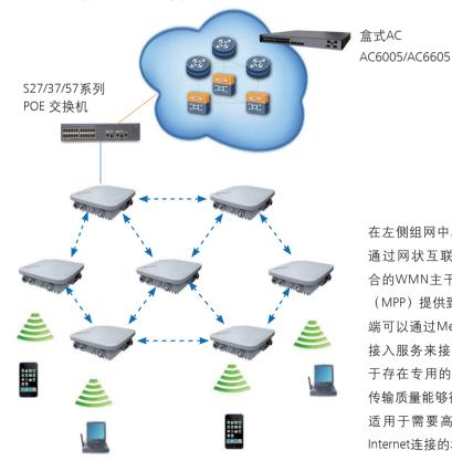
在左侧组网中, Mesh节点 (MP) 通过网状互联形成自配置、自愈 合的WMN主干, Mesh Portal节点 (MPP) 提供到Internet的连接。终 端可以通过Mesh接入点 (MAP) 的 接入服务来接入WMN网络中。由 于存在专用的Mesh路由协议,其 传输质量能够得到较好的保障, 更 适用于需要高带宽、高稳定性的 Internet连接的场景。
